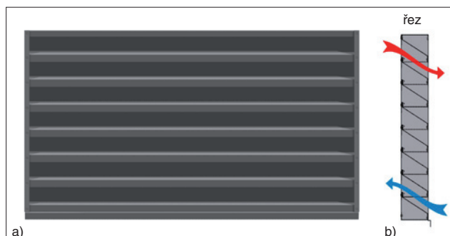
Obr. 3. Větrák LL a) čelní pohled, b) řez sestavou komor s naznačeným směrem proudění teplého a studeného vzduchu
