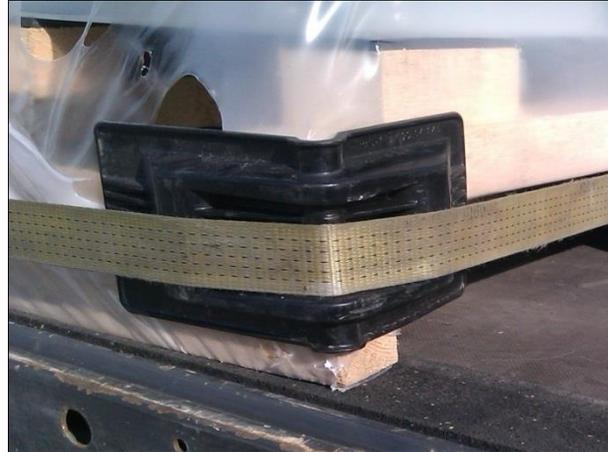
Direktzurren durch Kopflasching Verfahren über die Palette nach vorne. Der Winkel  $\alpha$  -rote Linie zum Fahrzeugboden- darf  $5^\circ$  nicht unterschreiten.
