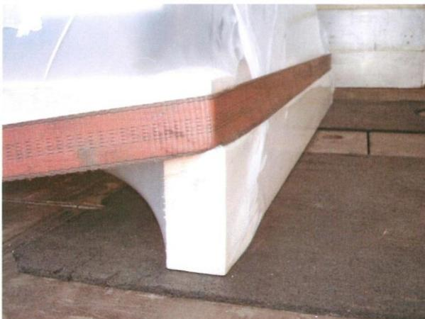
Abbildung 8: Sicherung gegen Herabrutschen
