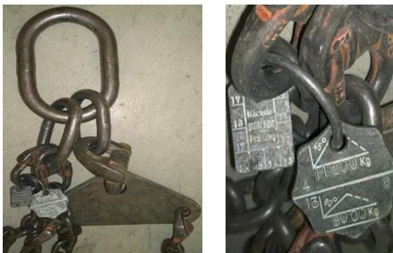
Abbildung 1+2: Kennzeichnung von Lastaufnahmemitteln gemäß Richtlinie 2006/42/EG
