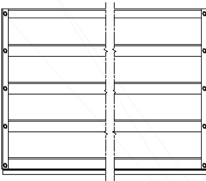
Abbildung 2 – Zeichnung und Schnitt Aluminiumlüftung LLE RC2 , Einbruchhemmende Komponenten nicht dargestellt
